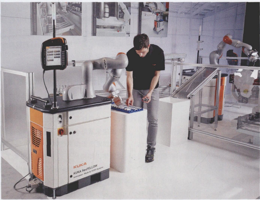
图 1 位置灵活的 Flex-Fellow 平台可以采用手动控制方式使其运行至工位，这样便能够采取手动和自动化相结合的方式完成工作任务
