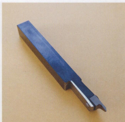
图 3 当摘去小零件时，机加工车间里的西铁城 A16 瑞士型机床上的副轴就会非常接近主轴。为了确保间隙，这个刀夹已在切削刃附近被磨得变窄。同时也对镶块进行了改进，以确保从其余的坯料中获得光洁的断面
