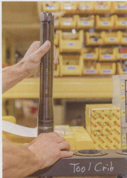
图 2 镗刀从主轴面伸出约 11 in，所以，在钻孔过程中减少振动是至关重要的
