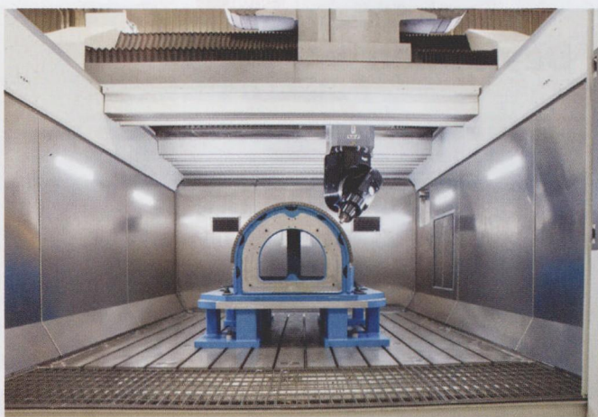
图 2 新机床具备的优良特性使其适合加工复合材料，其行程较大，五轴部件可以一次性加工完成，同时采用恰当的设计将部件抬升到工作区以上，以保护相关道路
