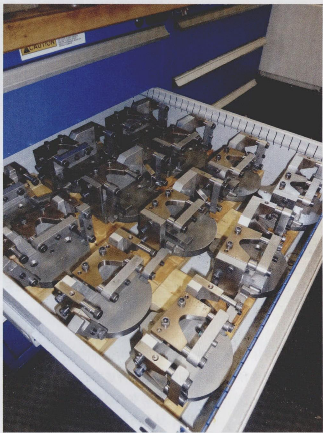
图1 附有固定装置的备用托盘已准备好装载螺纹铣削加工的工件，每个零件的加工时间不到 2 min
