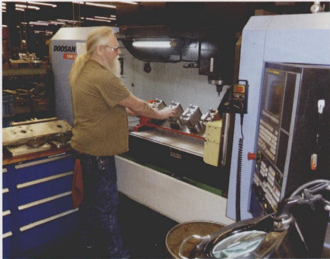
图 4 Carl Simpson 是数控机床的程序员 / 操作员，将已装载的托盘转移到 VMC。每个托盘的重量不到 6 lb，可减少操作者的疲劳，并可使更多的零件在工作结束之前，被加载到机床中
