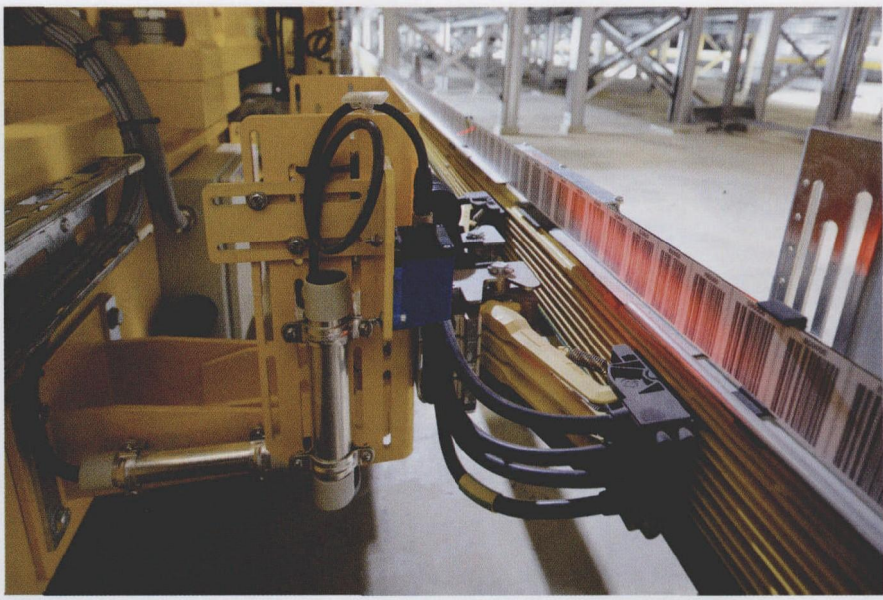
图3 使用条码扫描进行位移测量，用一个导电轨供电
