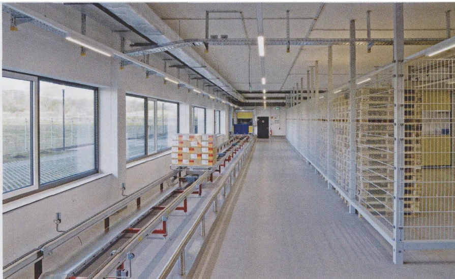
图 3 货物通过安装在自动化高架库底层的输送装置有选择地或直接将货物输送到高架库中，也可能
