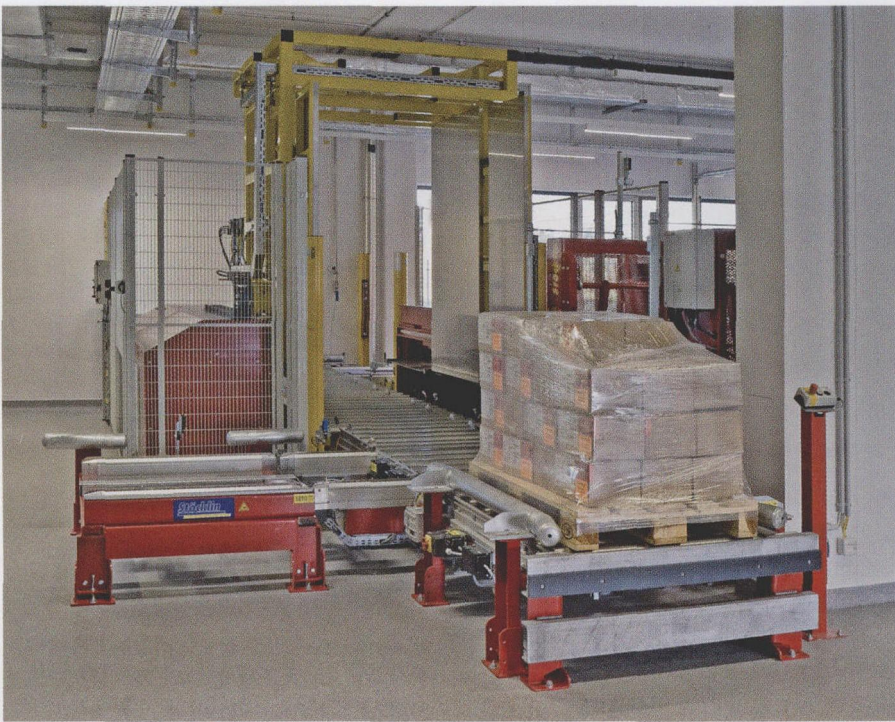
图 2 出于健康卫生方面的原因，EVER 耶纳制药有限公司将库存的货物从一个木制托盘推到一个铝制托盘上
