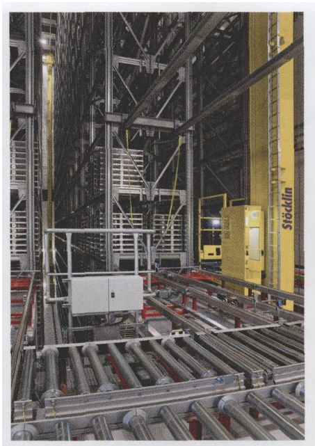
图 4 Stöcklin 物流股份公司研发的主杆结构系列货架操作装置从高架库准备区输送轨道处接收托盘
