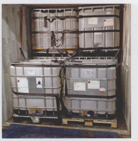
图 2 没有进行货物系固的居中的大容量集装箱 (IBC) 会在运输过程中出现滑移, 货物会因外壳破损而流出
