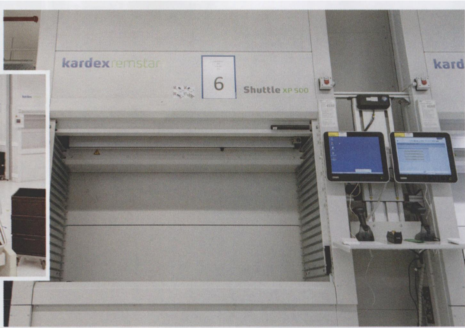
图 2 可跨越多楼层的卡迪斯自动化仓储升降系统 Shuttle XP
