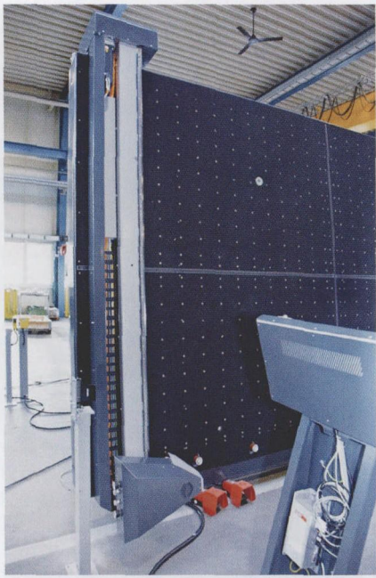
图 4 由于结构紧凑，控制柜式工业 PCC6930（右下）能够直接安装在操作终端，AM8000 伺服电机（左上）放在空间极为有限的切割工作台上，节省了大量空间
