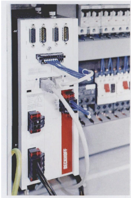
图2 双通道伺服驱动器 AX5206 同样有助于紧凑型机器设计
