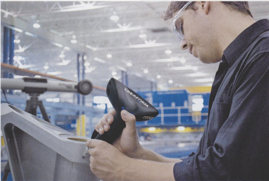
图1 手持式 3D 扫描仪实现了 22 \mu\text{m} 的测量精度
