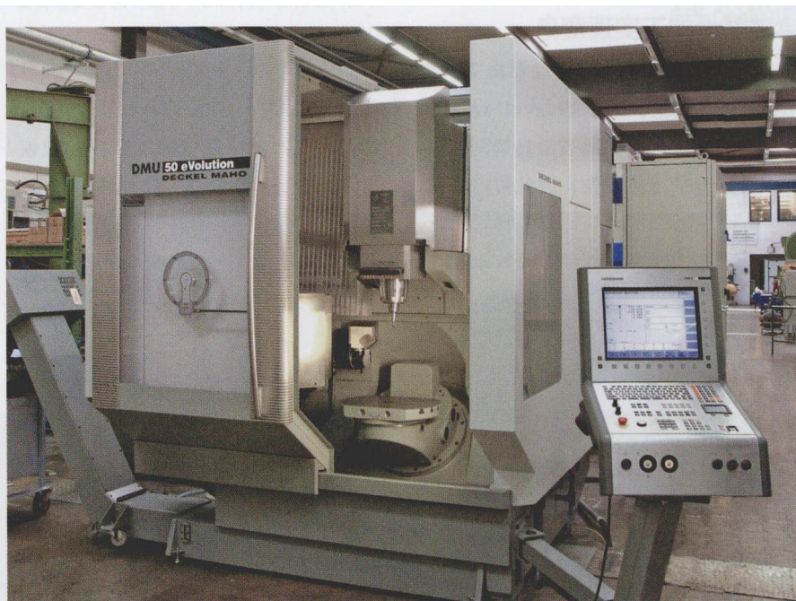
借助于 Deckel Maho DMU 50 evolution 型五轴加工中心可以进行相应的试验，以探索出与刀具磨损相关联的刀具切削特性
