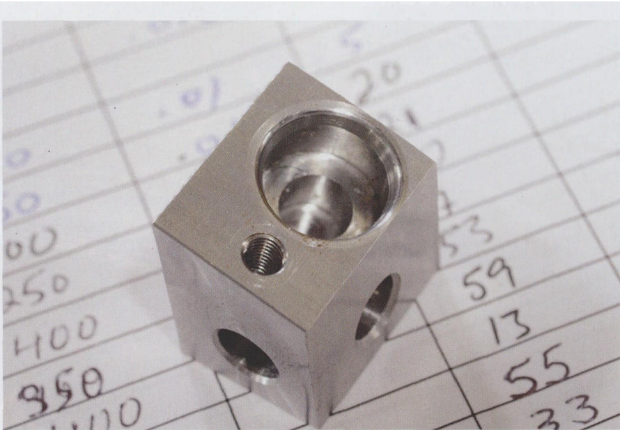
图 3 三位视图和强大的刀位轨迹将帮助 Forward Technologies 公司加工带有凹槽和复杂几何形状的 3D 零件
