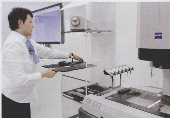
图2 托盘减少停机时间：当测量机仍在测量时，操作者可以筹划将下一组需要测量的工件放到托盘上。具有固定的标准球球座的校准托盘和球体节省更多时间
