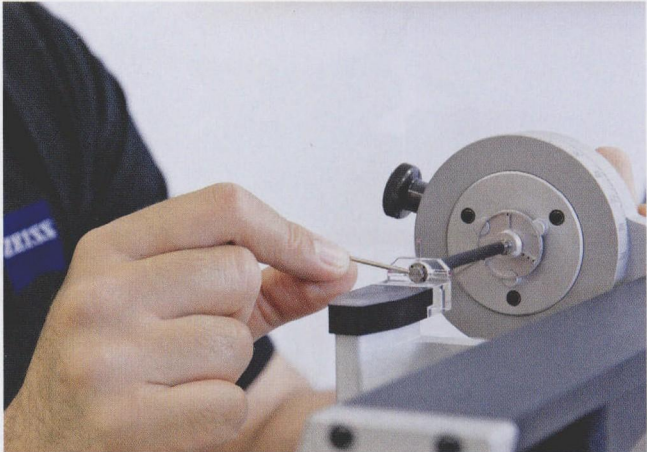
图 5 使用 FixAssist 探针调整设备，测量工程师可以快速、精确地进行探针调整、组装，更高的精度降低了碰撞的风险，同时设置更复杂的测针系统，意味着每个测量过程可能测量更多的特征
