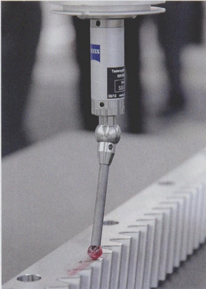
图 6 特别是 ZEISS FlyScan 等软件选项可以减少一半的测量时间，这些选项可以使测针在扫描过程中快速地在表面上的空间移动
