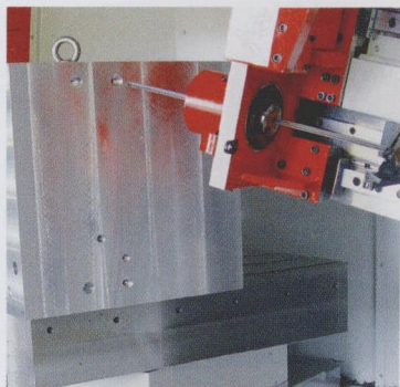
图2 采用深孔铣加工中心进行加工，在立方形工件上的孔的精度可以达到 \pm 20\ \mu\text{m}
