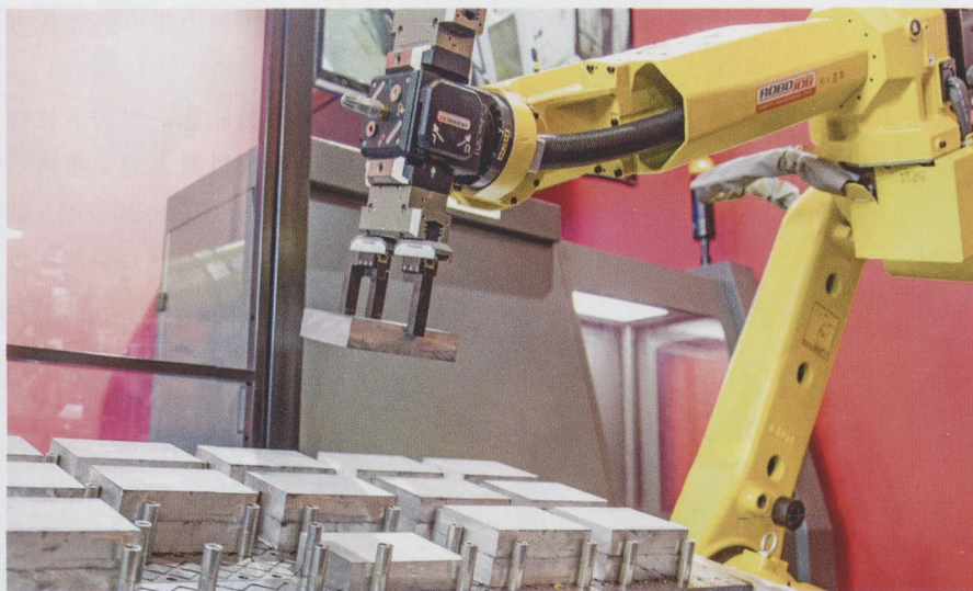
图1 机器人通过承担如去毛刺、定位或刀具更换这些伴随动作来辅助机床的加工作业
