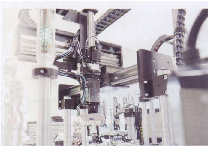
图 3 雄克的低磨损度、低维护率线性直轴可通过 Profibus DP、EtherNet/IP 和 EtherCAT 等多种现场总线进行控制，提高了装配过程的灵活性
