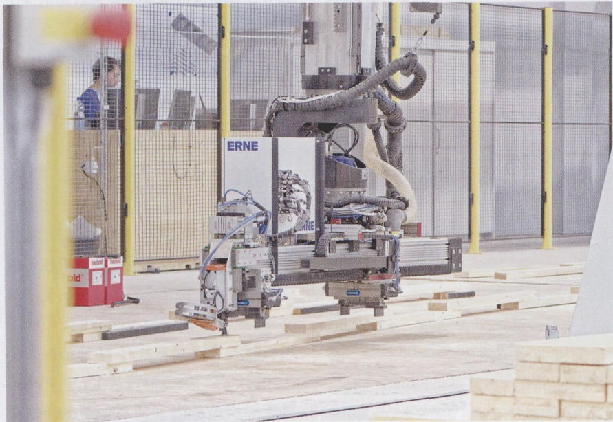
图 1 木板条一旦定位，便全自动化地被钉子钉牢
