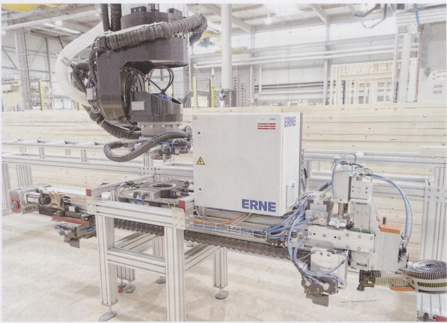
图 3 为了进行墙模块生产，该真空木板夹具能以秒计算地快速进行更换，该真空木板夹具装备有 Schunk 公司研发的快速更换系统
