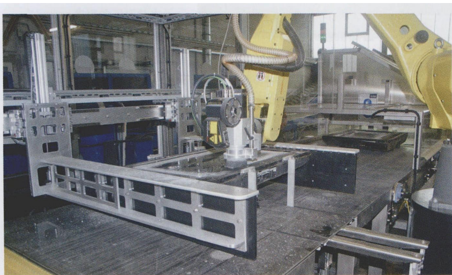
图1 输送带上所输送的液晶（LC）显示器输送进来后，接着便被送入到回收贵重原材料的作业站点
