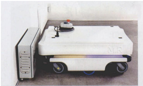
图 1 MiR100：在对接站工作的小型四轮运输机
