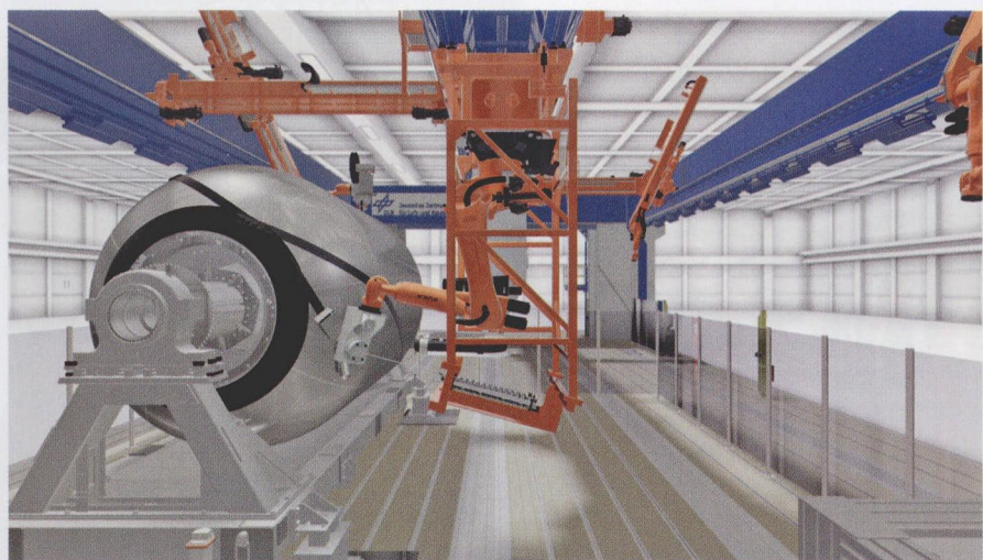
图1 整个助推器采用CFK（纤维干式缠绕和压条加工方法）制成：图为助推器的外观，KUKA公司提供制造阿丽亚娜6运载火箭的固体燃料发动机外壳样品的设备技术
