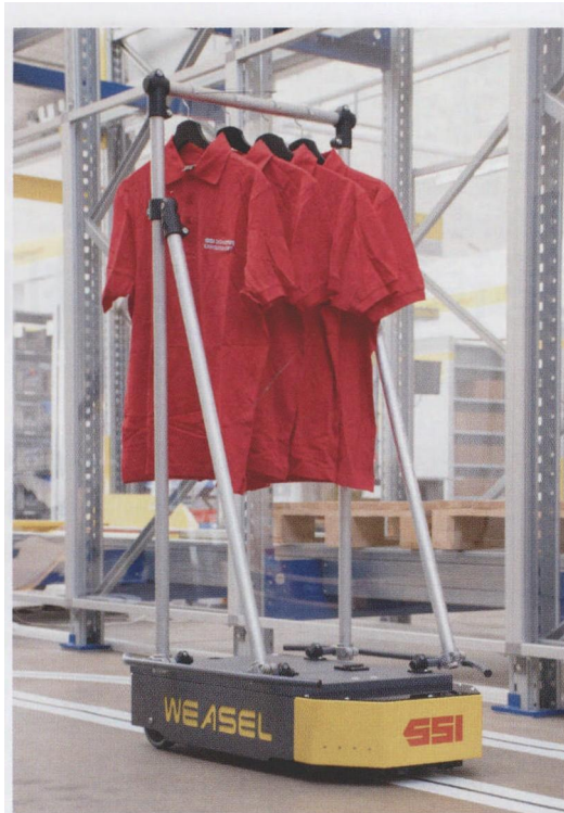
图1 WEASEL 无人驾驶运输系统在悬挂物品的库房内的物品挑选处理作业场地进行作业
