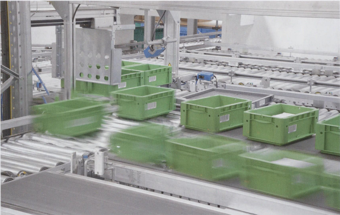
图 2 德国 Witron 物流和信息技术有限公司的创新：该库房挤实站能够使库房的能力得到最佳利用
