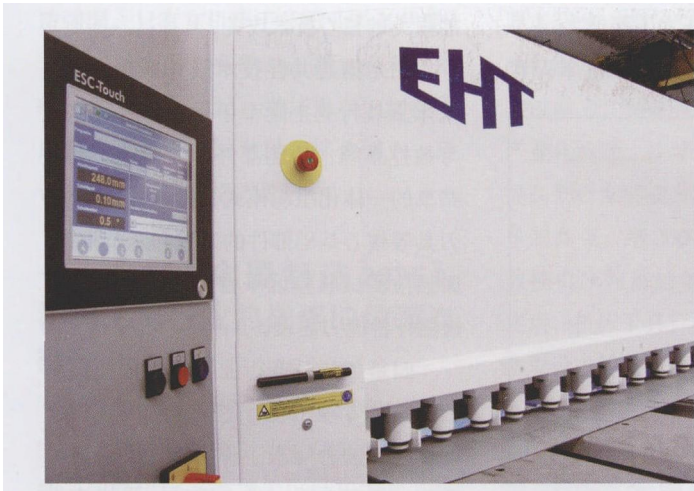
在 MultiCut 剪板机上，交流电机由 ACOPOSinverter 控制，从而实现了原本只能通过伺服电机才能完成的机动后挡料精确定位
