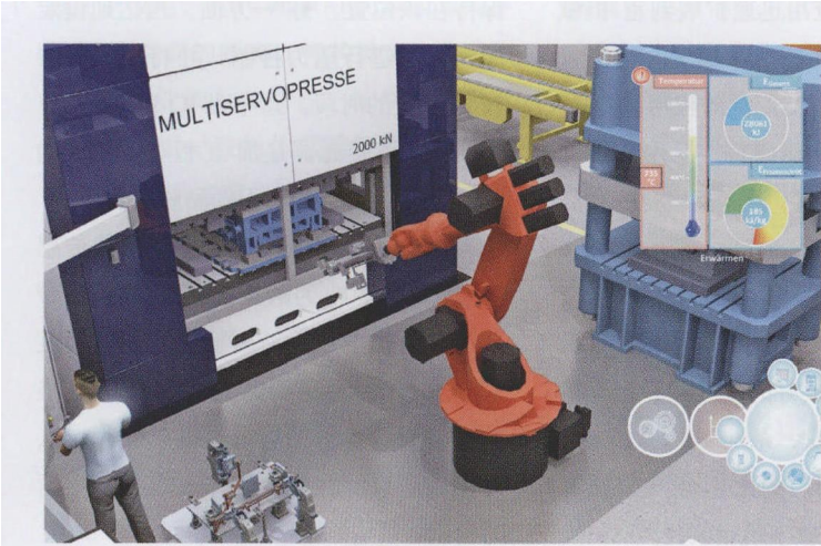
图 2 为了设计和验证研究，首先要搭建一个虚拟的工序环节 3D 模型，来反映接近实际情况的程序数据
