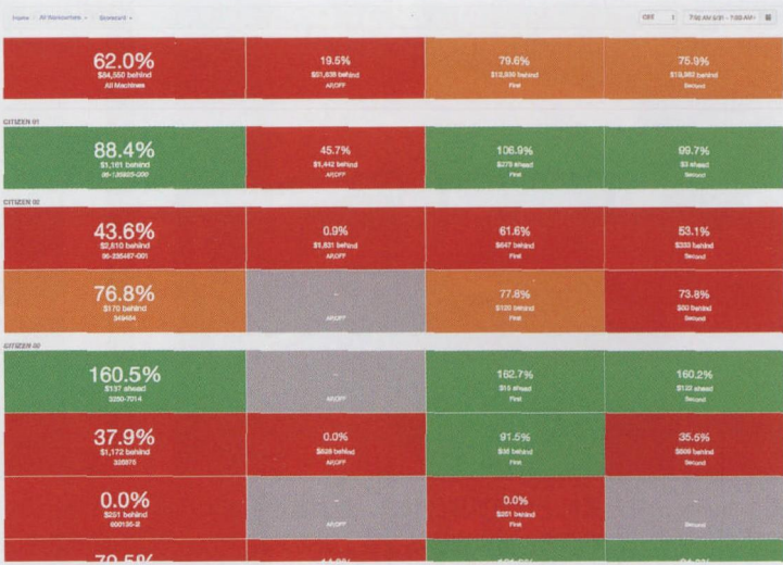
图 4 计分卡报告概述了每项工作的总体设备效率( OEE ),每个班次需要单独评级。它还显示每项工作背后的美元金额
