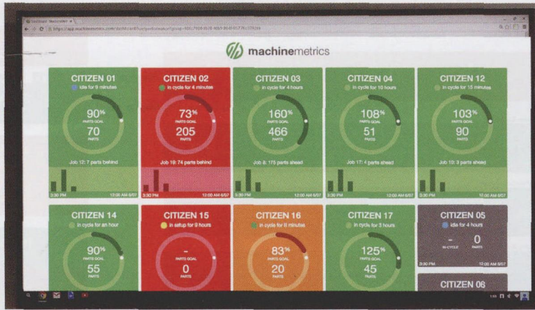
图2 每台机床都是由实时仪表板和工作中心视图上的图块来表示。圆形图通过生产周期显示进展的点，表明机床如何紧密实现其目标
