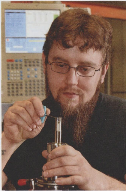
图 2 Di-Pos Tetra 铣销刀具分度一般耗时不到 1 min。现在仅需每 2.5 h 一次，而之前的标准工装需要每 10 min 一次
