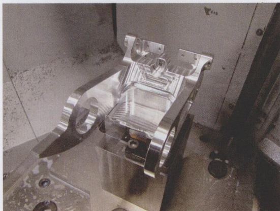
图2 这个零件通过使用动态运动选项为某些粗加工和精加工操作准备的刀具路径，提供了一个很好的示例
