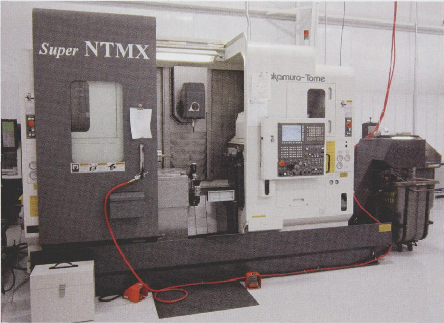
图 1 车铣复合加工的关键设计元素包括铣削主轴，可提供 \pm 95^\circ 的 B 轴旋转，双自动换刀装置，
