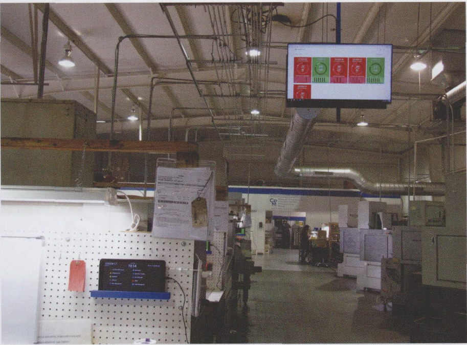
卡罗来纳精密制造公司在 Mooresville 的机床监测系统可以与每个工作站的输入板和大屏幕显示器进行无线连接
