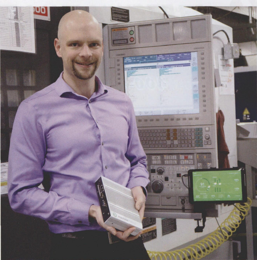
图 1 MachineMetrics 的 CEO Bill Bither 支持使用带两个网卡的网关设备将机床网络与公共互联网分开
