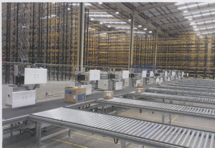
图1 Sortec公司研发的分拣输送系统可以完成例如大小不同的包装盒、空周转箱、包装的卫生纸、折叠起来的纸箱、堆叠起来的周转箱或者装有敏感类产品纸箱的分拣输送
