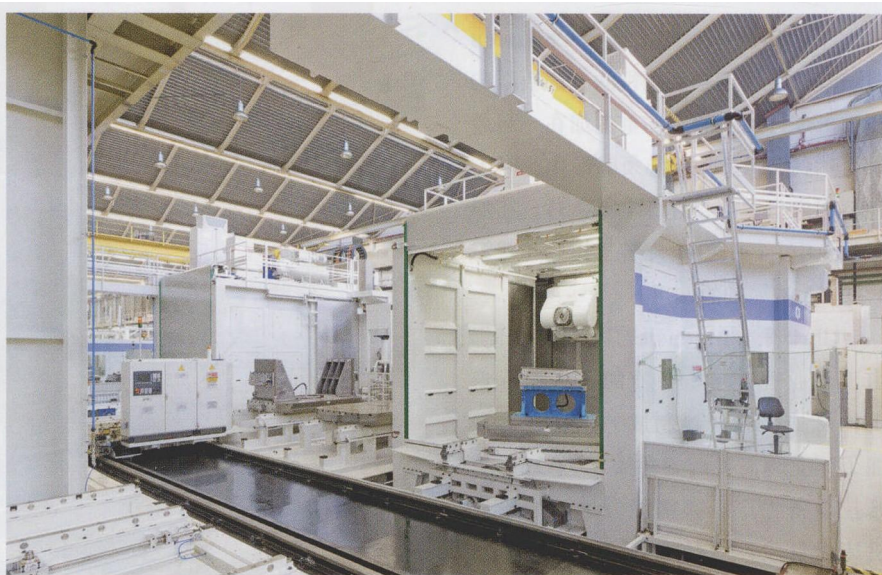
图 2 在对各种不同的飞机结构件的铣加工作业中，零部件张紧装置可将钛工件精准定位
