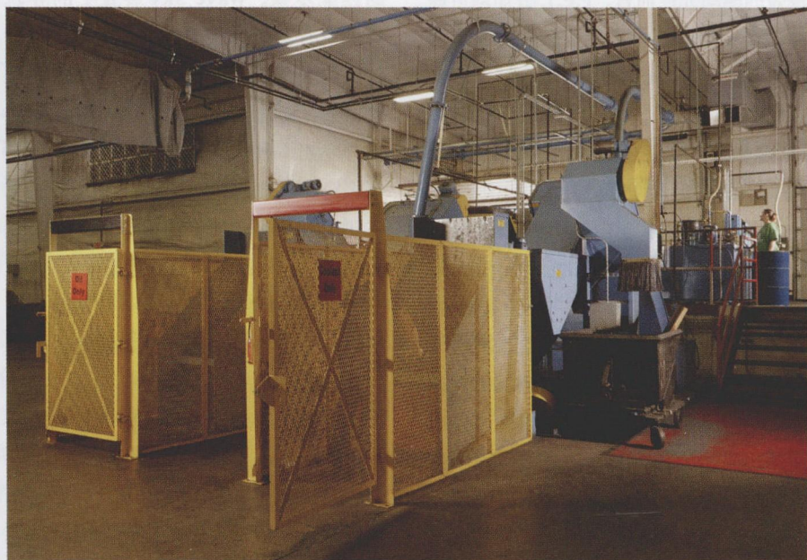
图 1 Nebraska Machine Products 公司在其回收区域投入了大量资金，该图像的前端显示了切屑脱水系统，并且冷却液循环系统位于凸起的区域中
