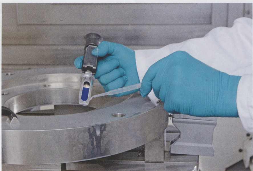
图 2 在 CNC 铣床上对冷却润滑剂进行取样
