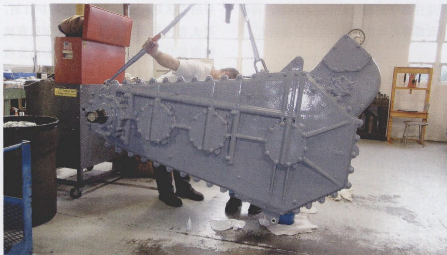
图 5 再修复变速箱需要安装新齿轮、轴承和密封圈，这时，在使用密封胶前，将螺母仔细收紧在螺栓上
