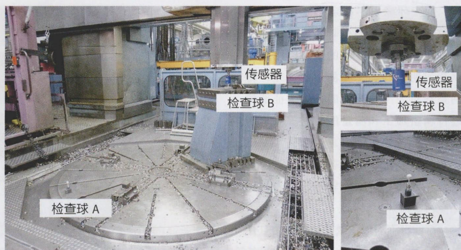
图3 在旋转台上采用3D测量头对几何外形精度进行快速检测
