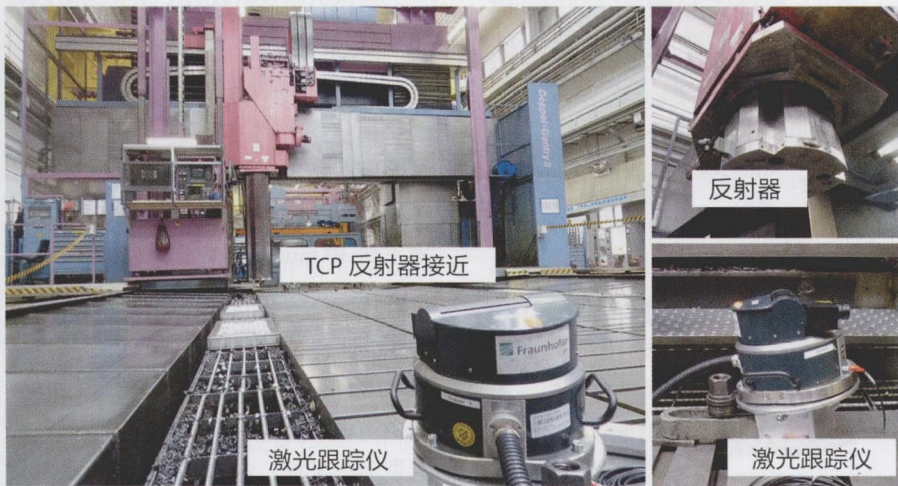
图 4 采用跟踪干涉仪对龙门加工设备的几何外形精度进行快速检测
