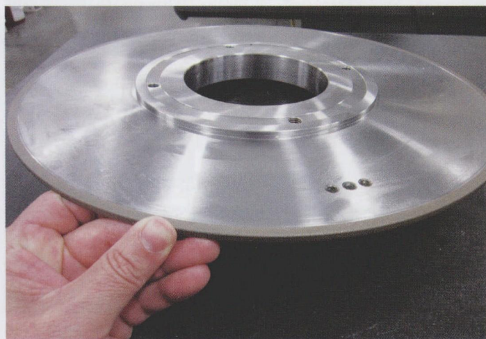
图 2 Complete Grinding Solutions 公司采用了金属结合剂砂轮（宽度为 5 mm，直径为 400 mm）进行高速剥皮磨削加工
