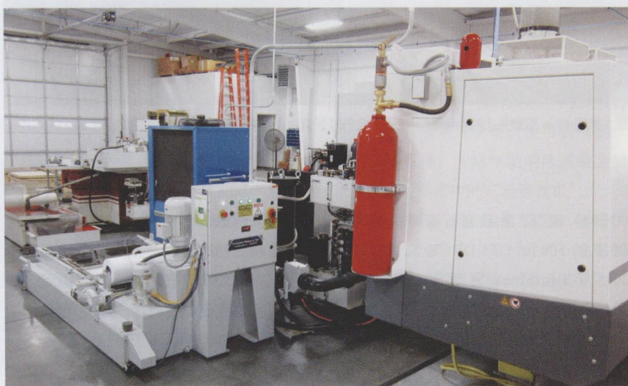
图 4 S41 上还设置了一个冷却装置，以保持冷却液处于低温状态，另外还配备了冷却液过滤系统和油雾过滤系统来收集油雾，使机构保持安全和清洁状态
