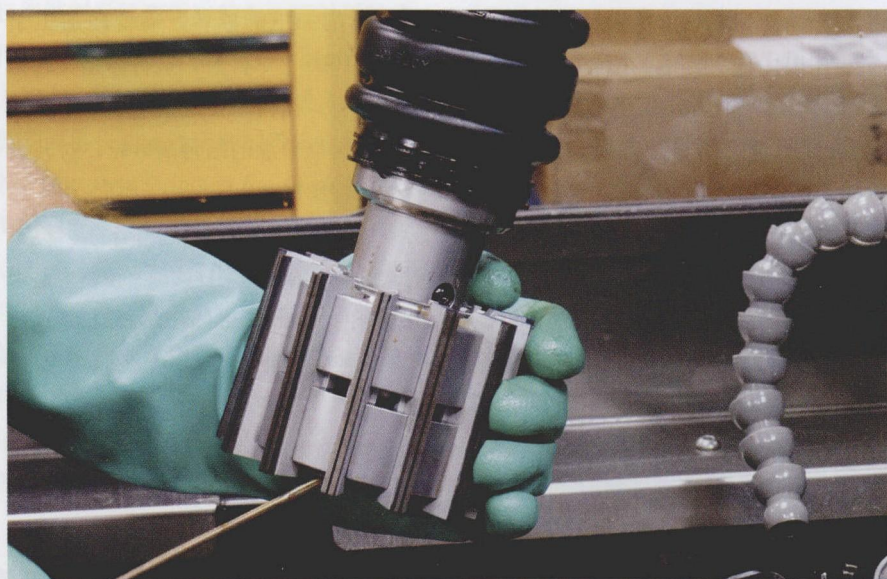
图 1 善能 12 in 珩磨头上的金刚石，在协助全气缸长度上的良好钻孔几何结构方面展示了极大的作用
