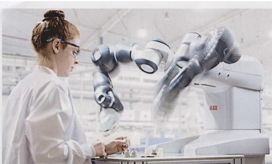
图 4 Yumi 机器人是 ABB 公司的未来幻景，与人合作式双臂机器人能够持续变换着进行小件安装
