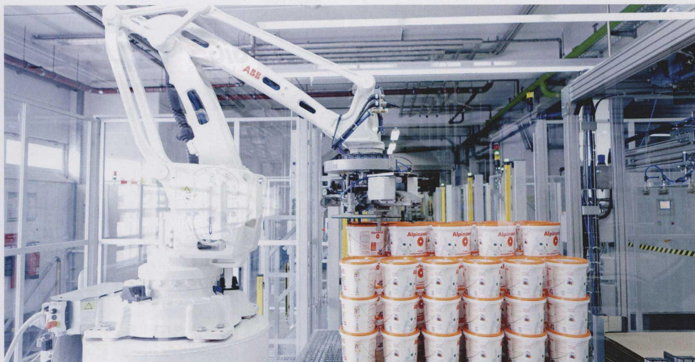
图 1 DAW SE 公司采用 ABB 公司的机器人自动化生产线解决了颜料桶盖封和托盘化方面的生产作业瓶颈问题，颜料罐装作业的生产效率大大提高，最重要的是能够灵活完成最多 28 种不同颜料的颜料桶罐装作业
