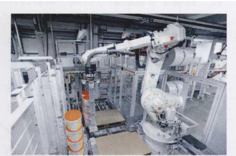
图 5 在为 18 种不同类型的颜料桶罐装颜料的生产作业中，该新的装置每小时可罐装颜料 680 桶并能完成 25 种不同的托盘图象
