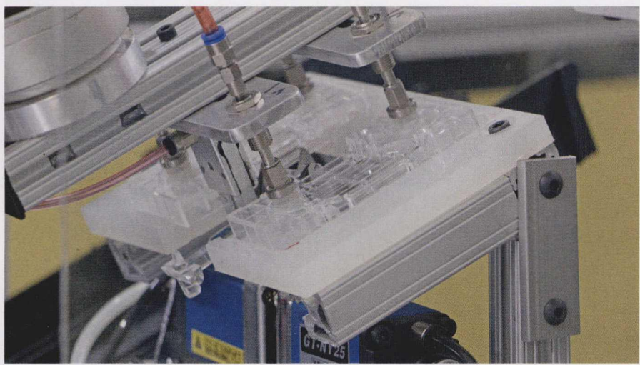
图 4 Dynamic Group 集团公司将 3D 打印的机器人臂端工具和 UR 机器人应用于注塑作业
