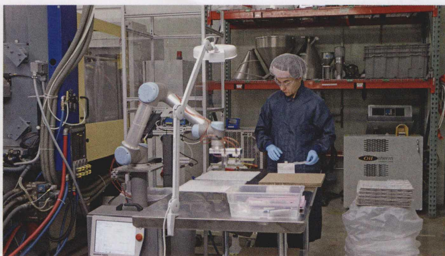
图3 Dynamic Group 集团公司将在注塑作业中使用由供货厂家事先已经装有码垛程序的 UR 机器人，该 UR 机器人负责将注塑好的工件送到工作人员面前的工作台上
