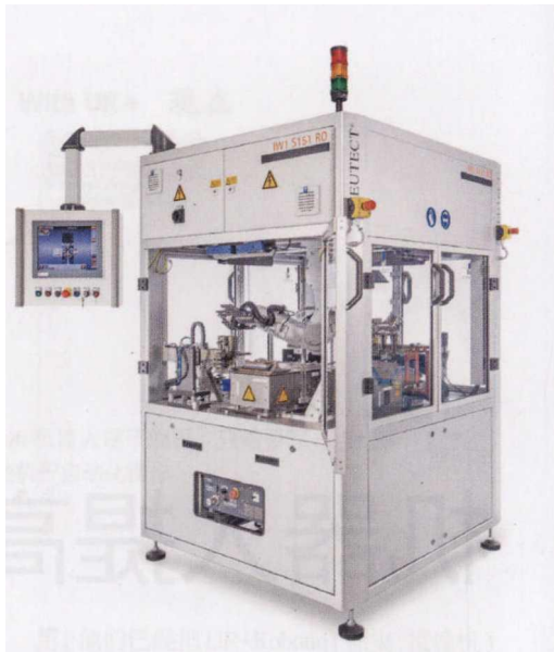
图 2 操作人员采用 Eutect Machine Interface (EMI) 操作界面能够在不具备相关专门知识的情况下对该装置进行程序化
