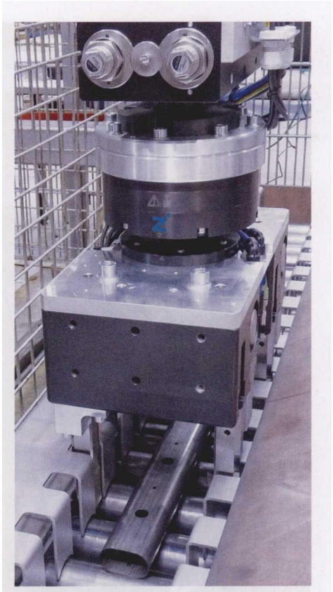
图 2 为了能够接着将切割成段的管材放在板条箱里的正确位置上，两个夹具通过一个共同的底板安装在水平回转单元上
