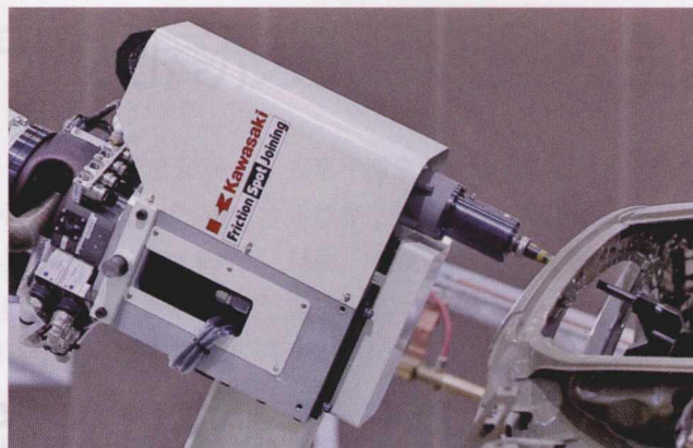
图2 摩擦搅拌点焊 (FSJ) 焊枪
