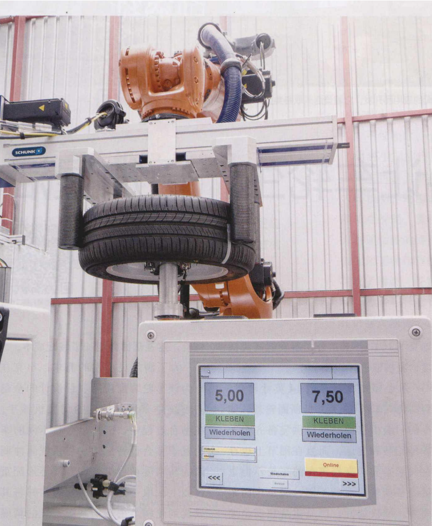
图 2 一旦发现车轮某处不平衡，单独定义的平衡块就会固定到粘合集。可以通过预置机械手指来匹配不同尺寸的车轮，从而优化周期时间
