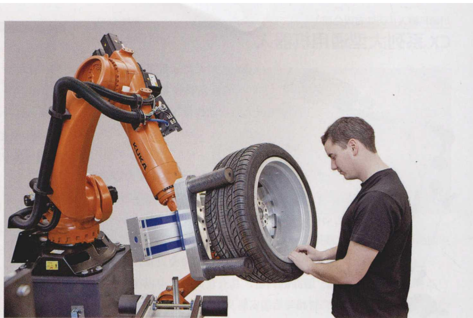
图5 雄克车轮机械手还可以实现半自动化应用，只使用一个机器人，该机器人会将机电式机械手调整到适合特定工人的理想作业高度，平衡块的位置由激光进行标记
