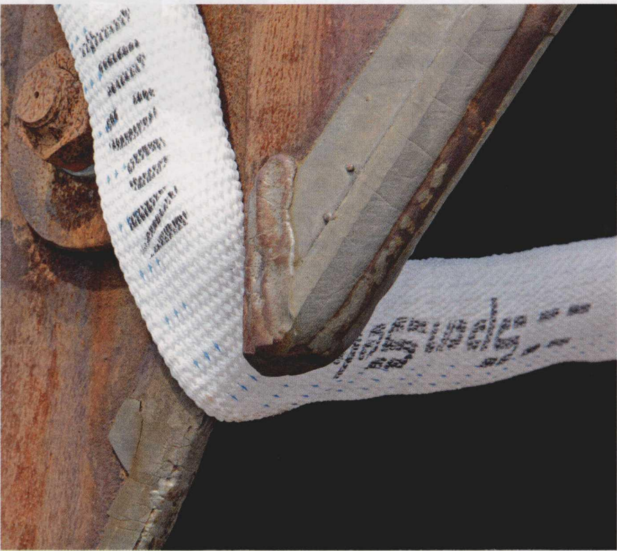
图 1 为了保护起重附件，可根据提升物体的类型选择适合的各种不同类型的保护软管
