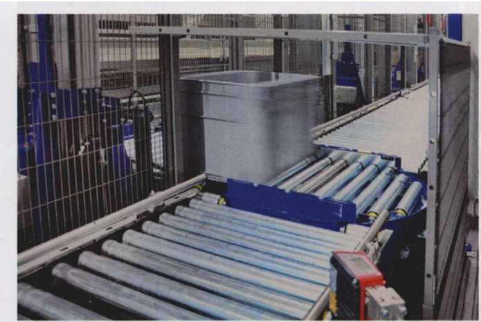
图4 一楼和二楼楼层高度的水平循环输送带每小时可以输送 400 个书籍收纳盒
