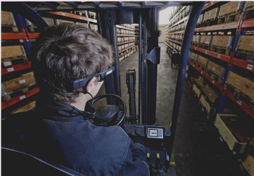
图 1 由于在整个仓库工作过程中解放了双手、采用了前后一致的物流过程控制技术，从而使的仓库保管人员也能够驾驶着叉车完成仓库物资的搬运了
