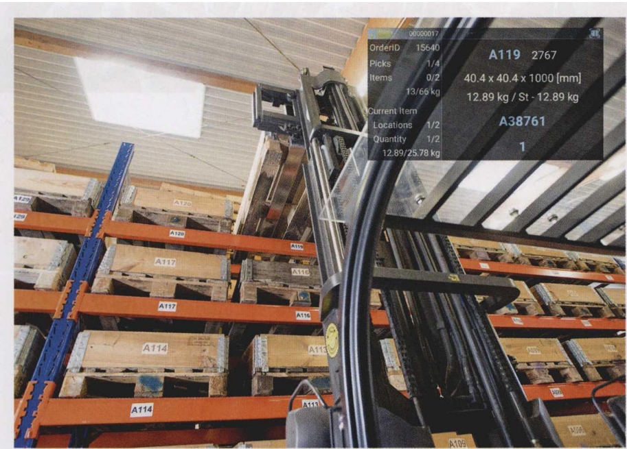
图 2 即便是较远距离的条形码，例如图示高架立体库上层架口中的条形码也都能被集成在数据扫描眼镜中的扫描仪识别出来
