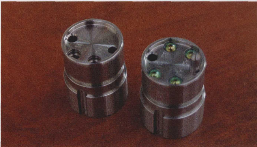
图 4 仔细观察光纤连接器插头, 光纤包含在直径为 2.5 mm 孔中紧密配合的陶瓷套管或套圈中, 其在连接端具有 3 mm 的沉孔, 以容纳该透镜
