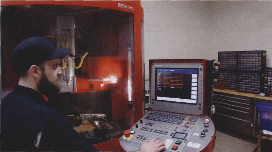
图 3 Integral Machining 公司生产经理和 Kern Evo 公司首席运营官 Sweeting 演示了 Heidenhain 数控机床示波器。该功能通过实时显示每根轴偏离其编程位置的距离帮助诊断错误源
